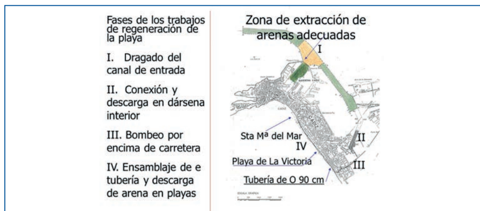
Fig. 1. Fases de los trabajos de regeneración de la playa de La Victoria con el dragado del canal del Puerto de Cádiz. Gómez Pina et al (2004).
