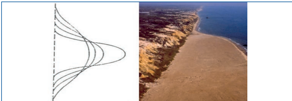
Fig. 7. Esquema del modelo one-line de difusión de la arena (izqda.) y Foto aérea del relleno de arena en Playa de Castilla. Fernández et al (1992)
