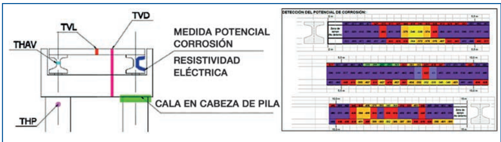
Fig. 13. Ensayos realizados y resultado del potencial de corrosión. Fuente: Nàutic Palamós / Marciglob (2021).
