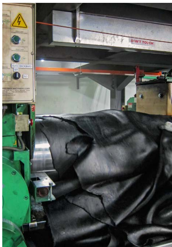
Compuesto acabado en tren de laminación
