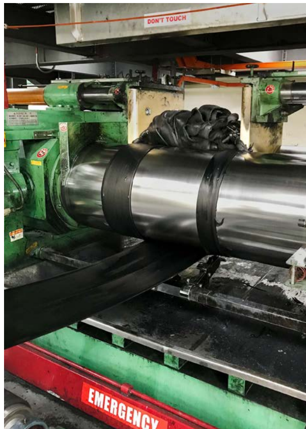
Concentrado de color en tren de laminación
