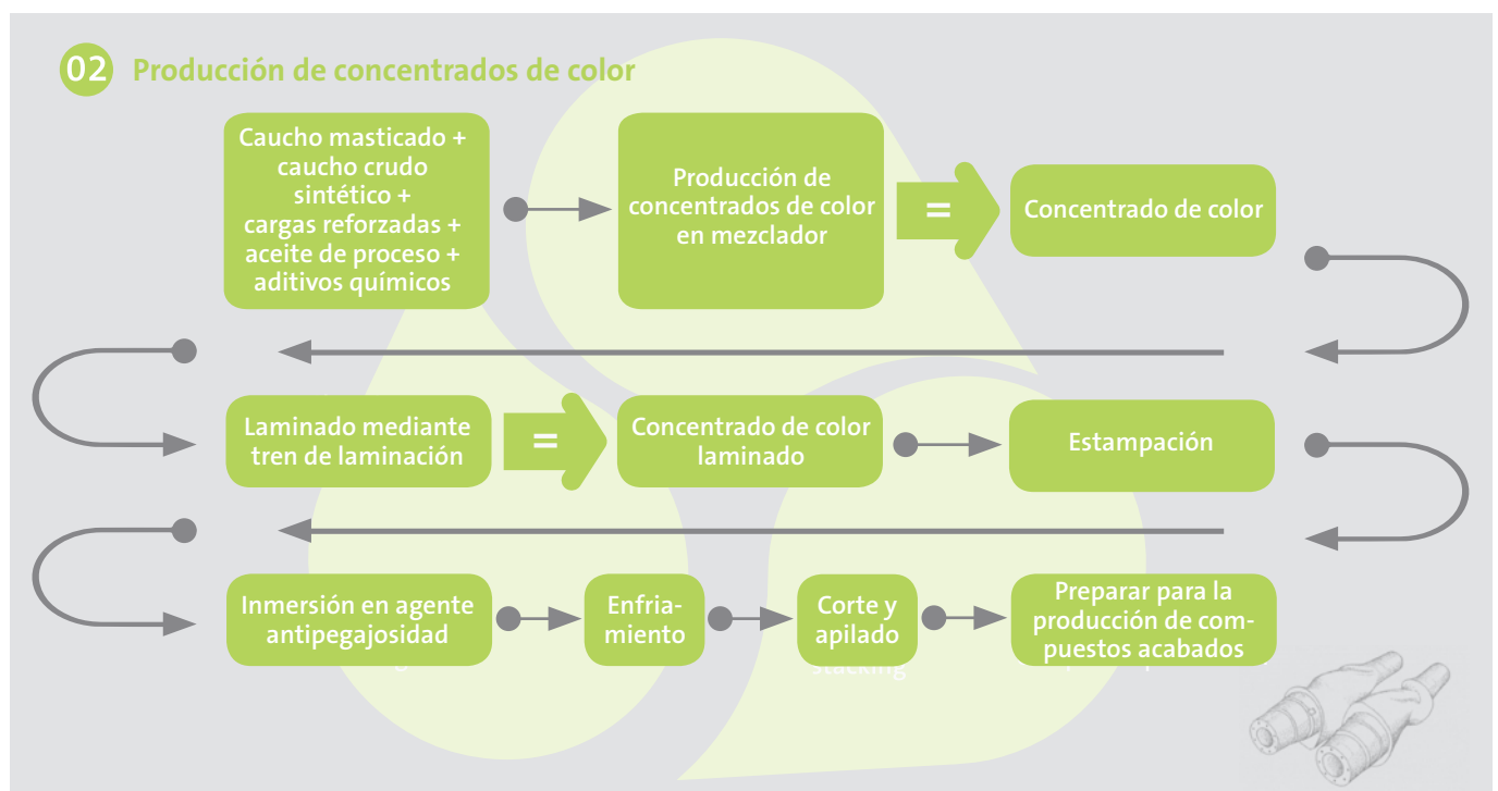
Figura 5: Producción de concentrados de color – Pasos detallados
