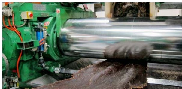
Caucho masticado en tren de laminación
