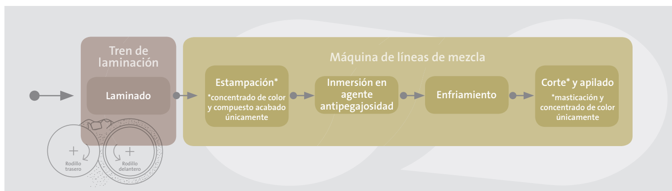
Figura 4: Proceso de mezclado – Tren de laminación y máquina de líneas de mezcla
