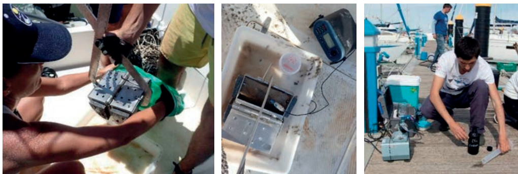
Draga Van Veen para la toma de sedimentos (izquierda) y análisis de parámetros físico-químicos en sedimentos (centro) y agua (derecha).
