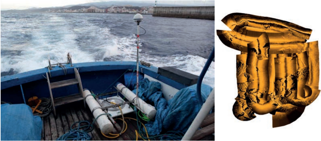
Figura 5: Boomer AA301 con catamarán y antena de DGPS y Mosaico Sonar.
