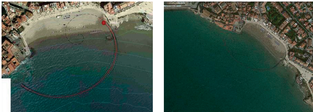
Figura 11: Forma en planta del nuevo dique sumergido.
