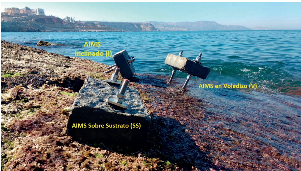
Figura 3: Disposición de AIMS ensayada: Sobre sustrato (SS), en Voladizo (V) e Inclinado (I).
