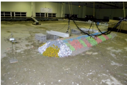
Situación actual del dique con bloques de 55 y 85 t con densidad 2,35 \text{ t/m}^3 (hormigón convencional), y bloques de 27, 48 y 60 t con densidad 2,70 \text{ t/m}^3 (bloques calizos).
