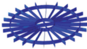
Índices de fallo de Tsai-Hill en refuerzos verticales y de base.
