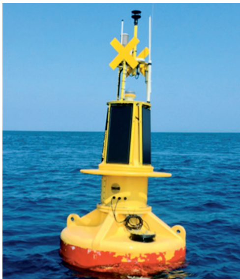
Figura 11. Boya de medición de las condiciones marinas y meteorológicas, instalada en el Punto de Vertido.
