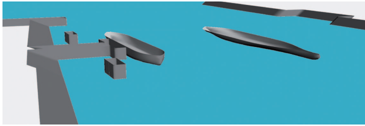
Figura 1. Modelo numérico de interacción entre buques (Ropes "Passing ships").
