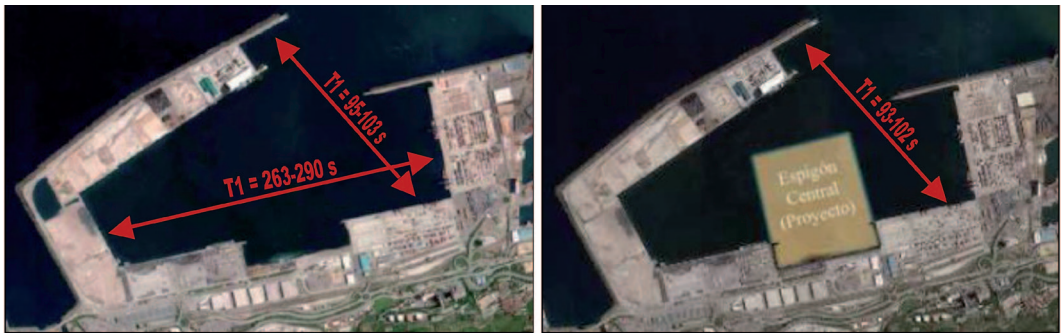
Figura 8. Periodos de oscilación detectados en el modelo físico para la configuración sin Espigón Central (izda) y con Espigón Central (dcha).
