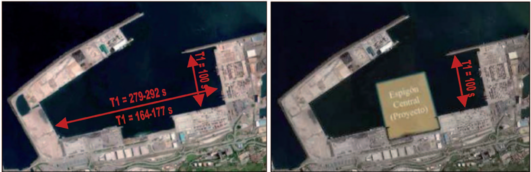
Figura 5. Periodos de oscilación detectados en el modelo numérico para la configuración sin Espigón Central (izda) y con Espigón Central (dcha).
