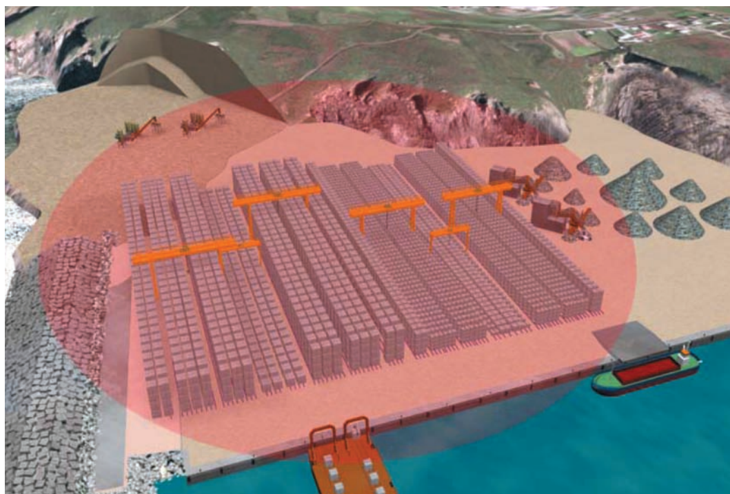
Figura 29. Oferta de Contrucción. Parque de bloques para el dique.
