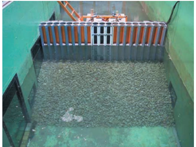
Figura 19. Modelo físico del dique.
