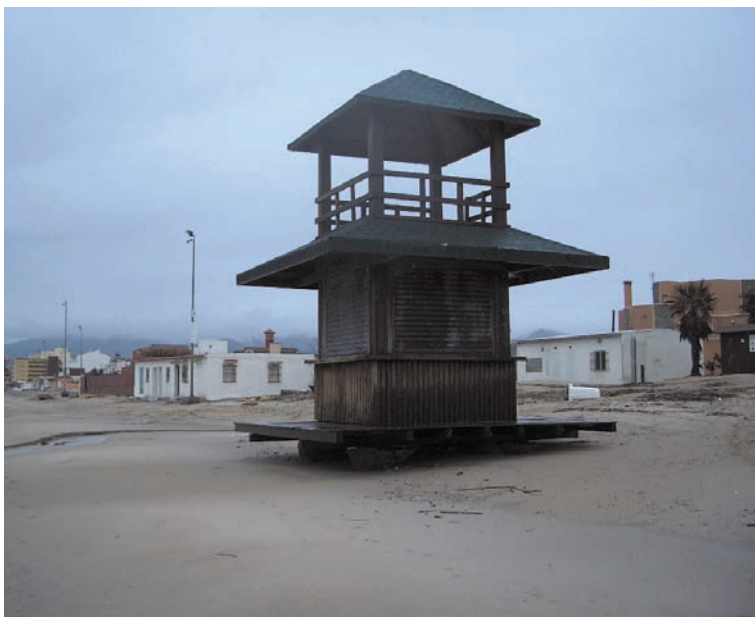
Figura 16. Pérdida de playa seca después de un temporal (por otro lado esperable) y falta de espacio para la adecuada reacomodación transversal del perfil de playa por el urbanismo inadecuado.
